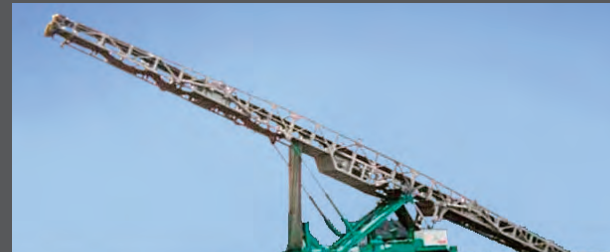
TBL3 搬送能力300t/h オプション:コンベヤ折畳み
